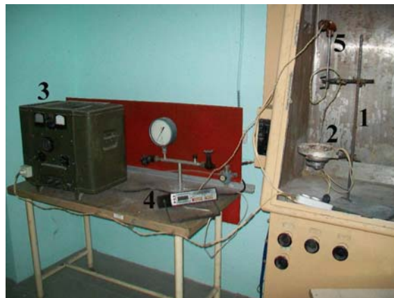
Рис. 3 Внешний вид установки для исследования теплофизических свойств
