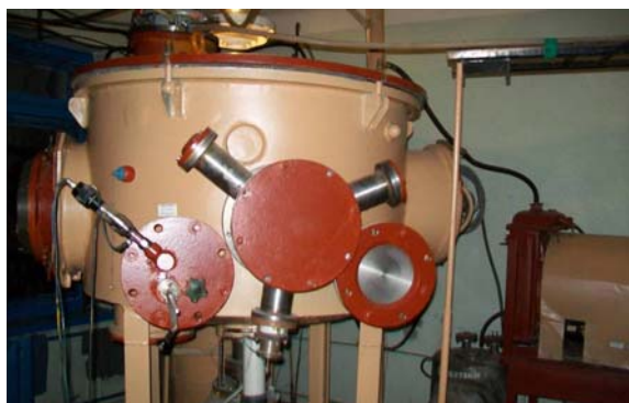
Рис. 2 Внешний вид установки ионной имплантации
