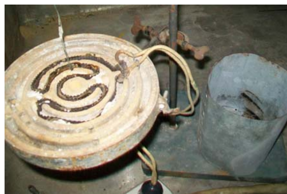
Рис. 4 Внешний вид нагревателя с образцом и экраном
