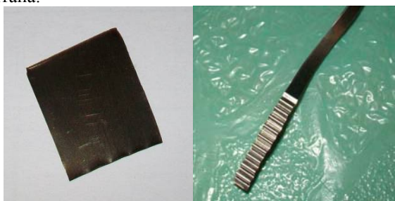
Рис. 1 Внешний вид исходной стальной фольги (а) и гофрированного образца (б)
