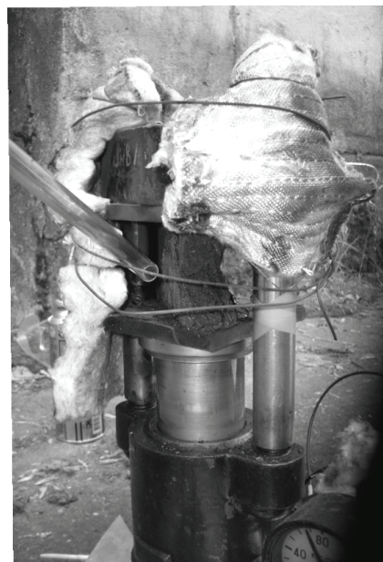
Рис.2 Внешний вид образца угля, помещённого в пресс, до начала нагрева.
