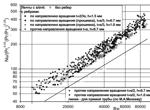
Рис.3. Зависимость теплоотдачи труб с различными скрученными лентами при s/d=6 от числа Рейнольдса Re
