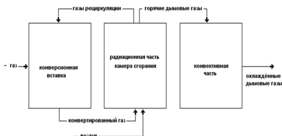
Рис.2. Блок-схема предлагаемого способа сжигания газа с предварительной конверсией.
